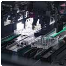
全新CCD拍照 产品外观不良识别检测，品质保障
