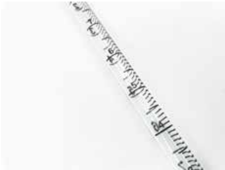
双向刻度线，便于识别移液体积，增加额外容量的阴性刻度
